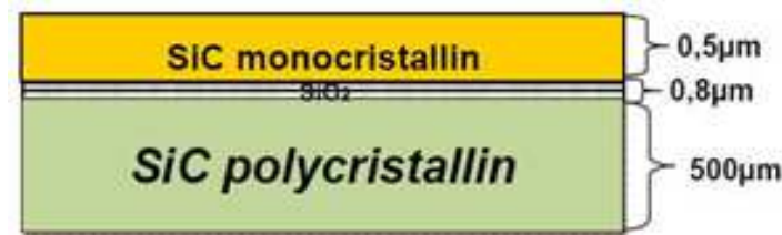
Figure I.5 : Schéma illustratif d'un substrat composite type SiCopSiC.
