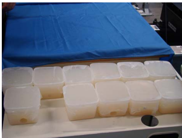
Figure 3.9: Fantômes à base de gel Agar-agar
