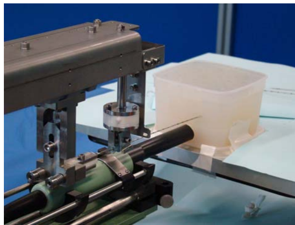
Figure 3.12: Insertion de l'aiguille dans le gel Agar-agar sous guidage échographique
