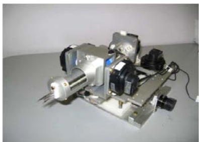
Figure 2.15: Robot médical multi interventions sur la prostate sous guidage IRM, source ©[Goldenberg08].
