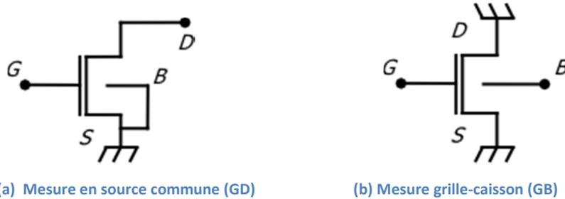
Fig. IV-5: Configuration des ports pour la mesure d'un transistor en source commune (a) et grille-caisson (b).
