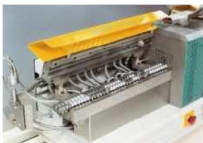
**Figure II- 5: Image de l'extrudeuse bi-vis co-rotative Thermo Prism PTW-16 de Thermo Haake**
