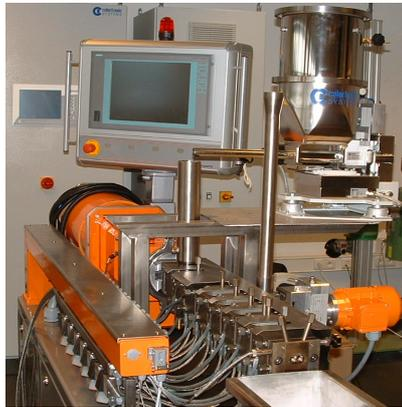
**Figure II- 7: Image de l'extrudeuse bi-vis co-rotative Lietritz type ZSE**
