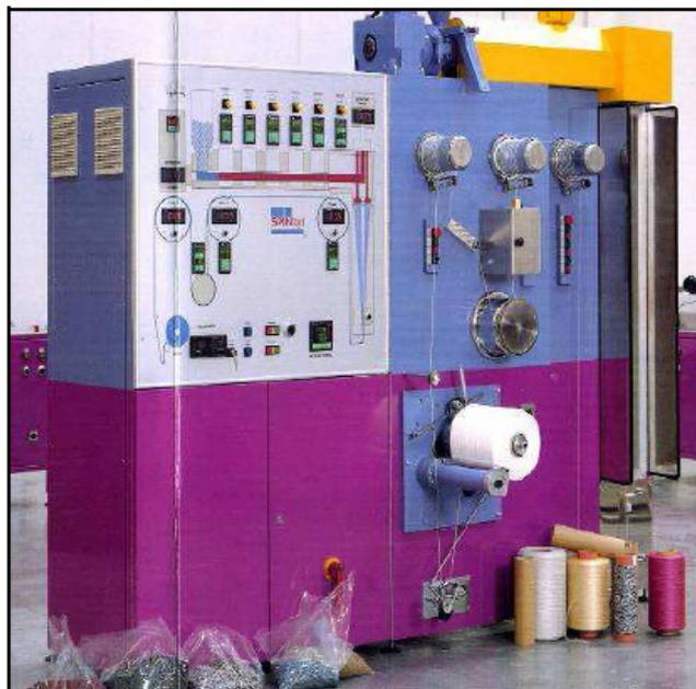
**Figure III- 1: Pilote de filage en voie fondue Spinboy I**
