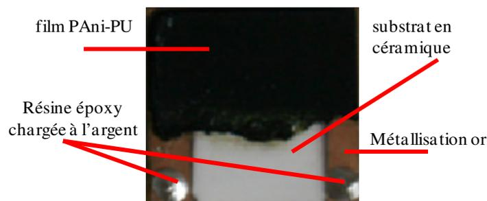
**Figure I-17** : Film PAni-PU déposé sur un substrat en céramique
