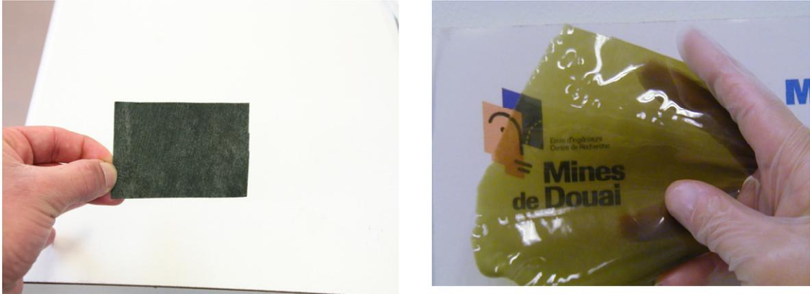
**Figure I-18:** Film de PANi/PU déposé sur fibre de verre (à gauche), et sous forme de film (à droite)
