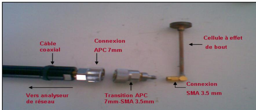
Figure III-13-a : Cellule à effet de bout
