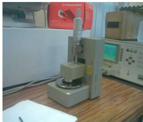
b- Tête de mesure diélectrique « agilent16451 B »
