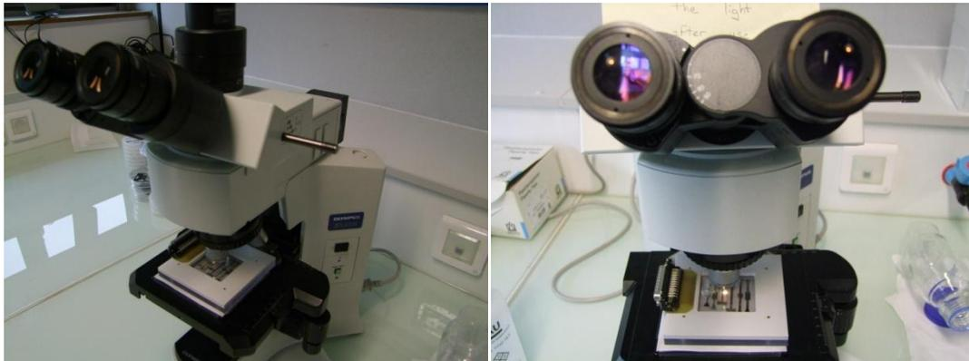
Figure 4.4 : Le phénomène de concentration est observé au microscope en réflexion en lumière blanche.
