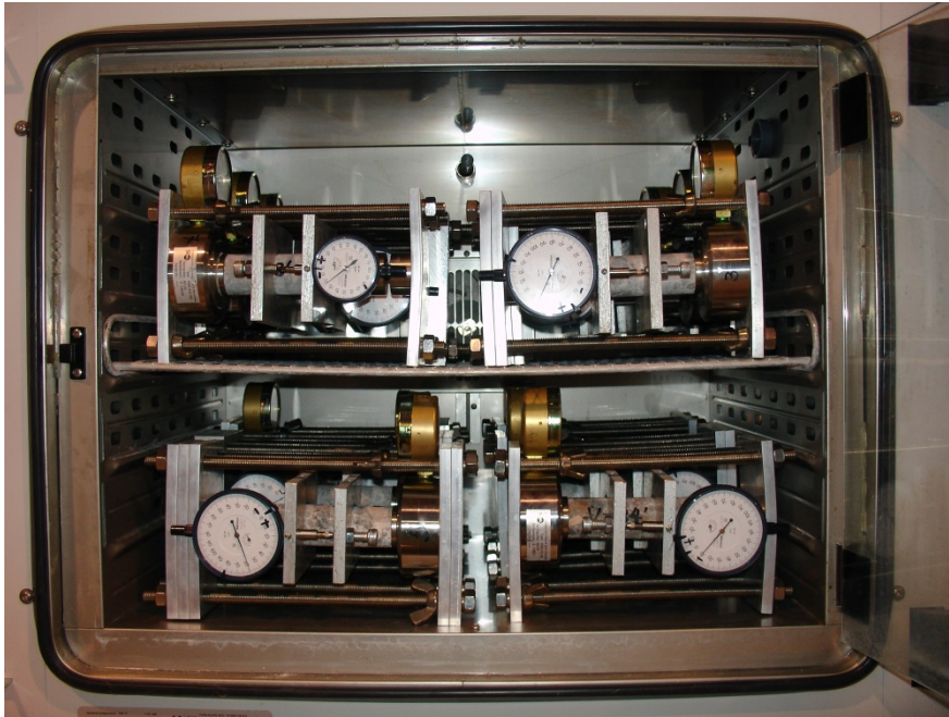
Figure 2.14 (a) : Les dispositifs de fluage uniaxial dans l'enceinte climatique
