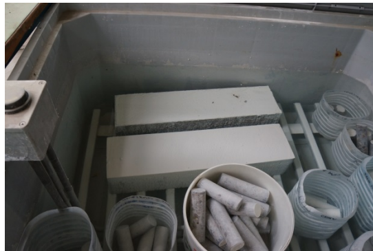
Figure 2.2 : Les poutres sont placées dans la piscine thermostatée à 20°C.
