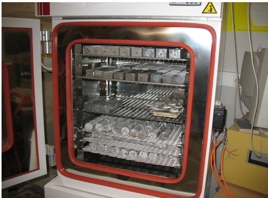
Figure 2.7 : Echantillons placés dans les enceintes climatiques
