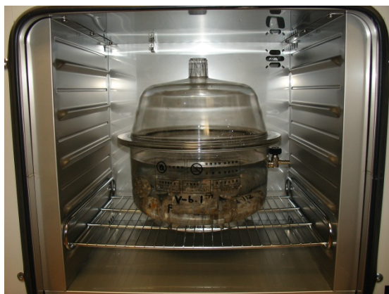
Figure 2.5 : Conservation des échantillons saturés dans un bain thermostaté sous température (20°C, 50°C ou 80°C)
