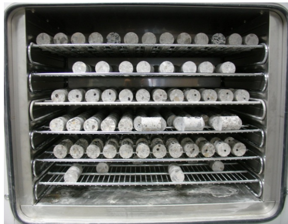
Figure 2.8 : Etuvage à 60°C des éprouvettes.
