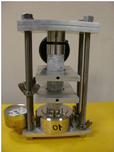
Figure 2.14 (b) : Conception initiale du bâti de fluage de dessiccation
