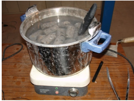
Figure 2.6 : Chauffage progressif des éprouvettes destinées à être conditionnée à 50°C et 80°C
