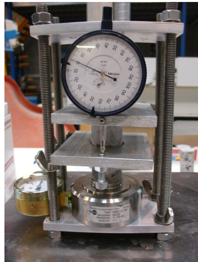
Figure 2.14 (b) : Conception initiale du bâti de fluage de dessiccation
