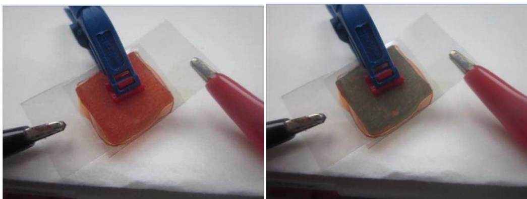
Figure 57 : Composite Tricot/polythiophènes avant et après l'envoi d'un potentiel électrique
