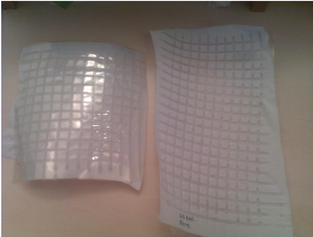
Figure 54 : Soudure d'un film de PET/ITO sur une face de Déco 200
