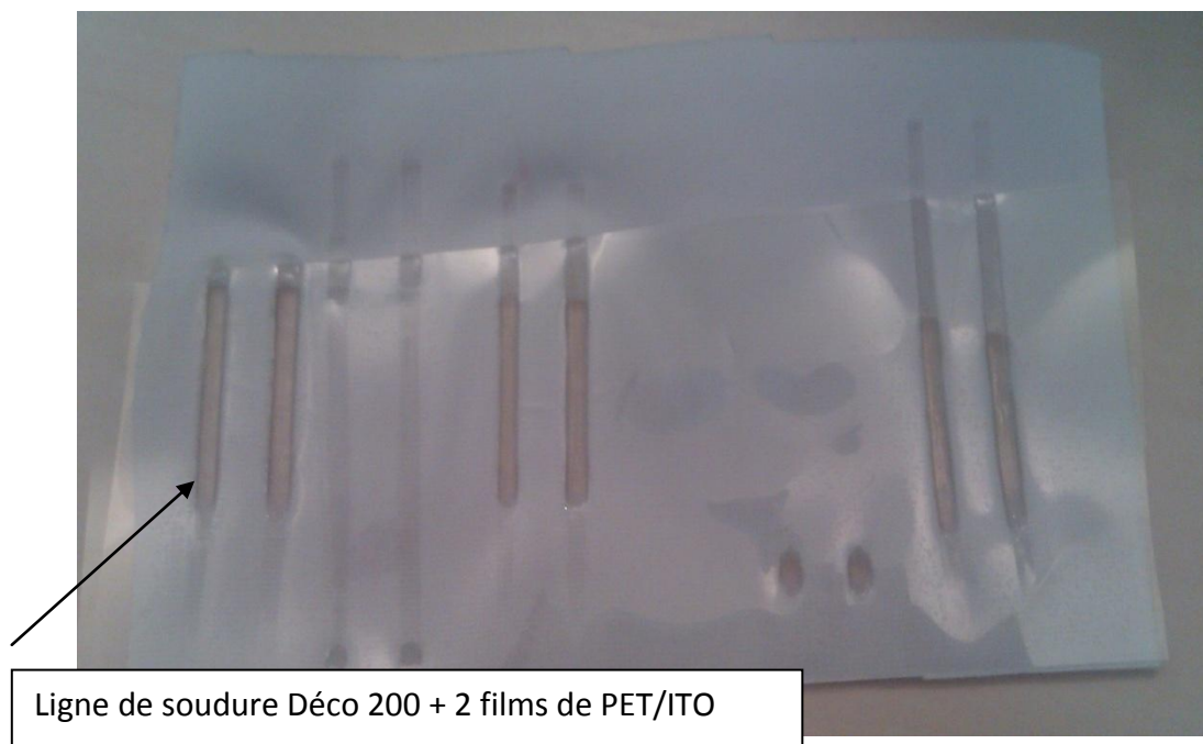
Figure 55 : Soudure de deux films de PET/ITO de part et d'autre du Déco 200
