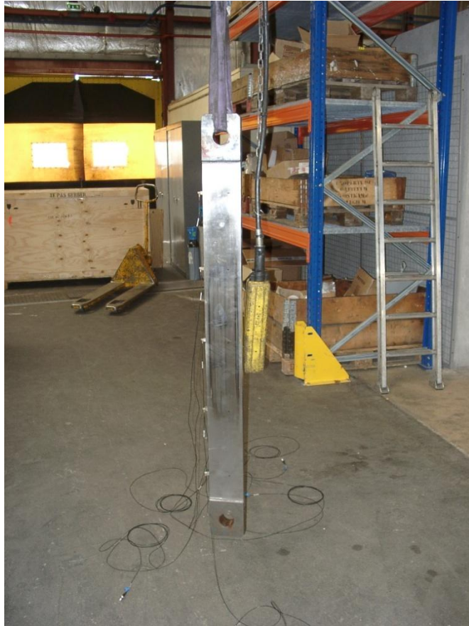
Fig. IV-1 : Barre suspendue pour l'analyse modale en libre-libre, les accéléromètres sont collés sur la tranche pour les mesures hors plan.
