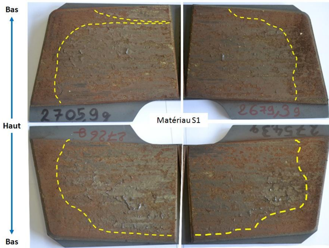
Fig. VII-16 : Surfaces frottées des garnitures en matériau de friction S1 après essai à 1080 m.
