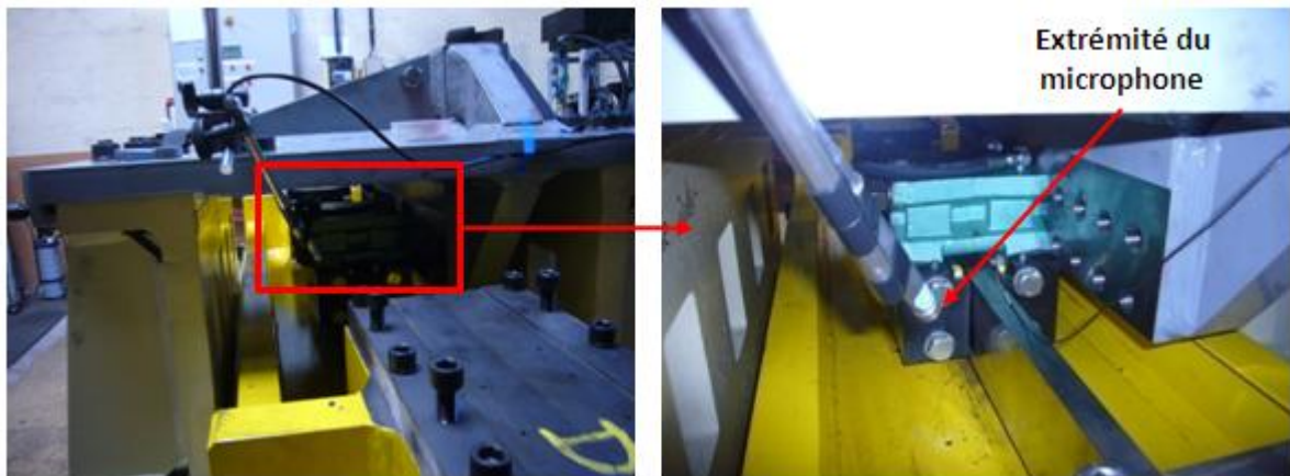
Fig. III-19 : Position du microphone sur le banc d'essai.
