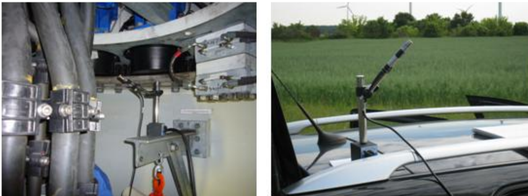
Fig. I-7 : Microphone à l'intérieur et à l'extérieur de l'éolienne.
