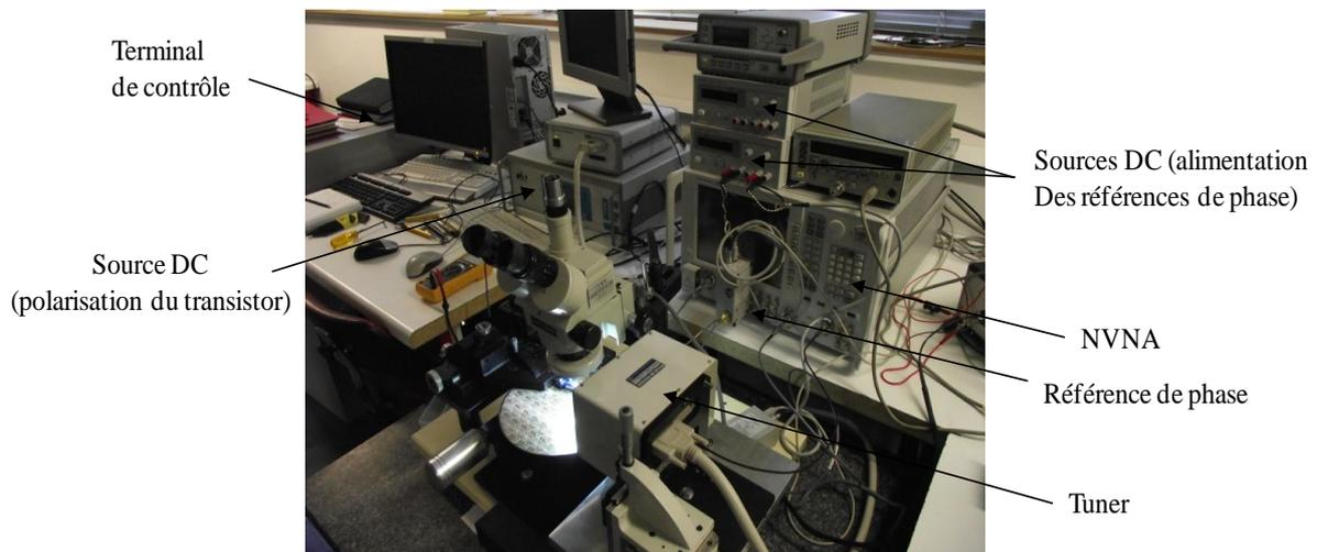
*Figure III.24 : Le banc NVNA en configuration Load-pull à charge passive*
