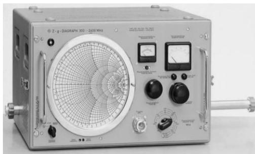
*Figure I.1 :  $Z_g$  diagraph de Rohde & Schwarz dans la bande 300 MHz-2400 MHz*
