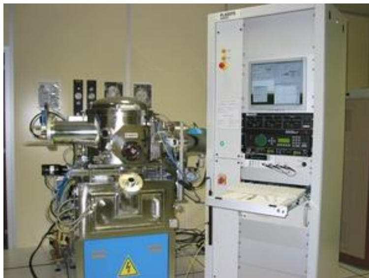
Fig. 3:1 Photo du système de dépôt par évaporation à canon à électrons de type PLASSYS MEB 550S.
