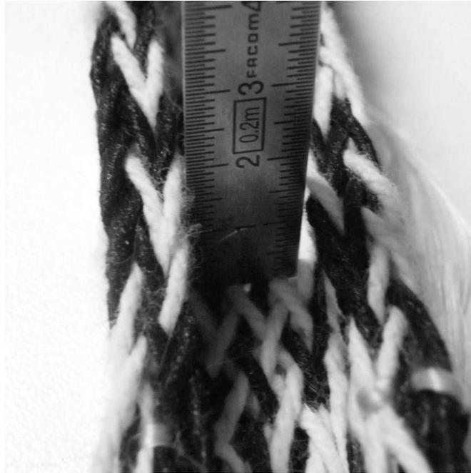
FIGURE 2.18 – Profilé tressé avec une section « U », estimation de la hauteur d'un des voiles
