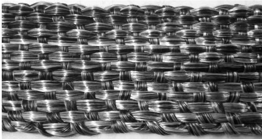
FIGURE 2.22 – Tissus interlock en Twintex® , liage couche à couche sur 3 niveaux.
