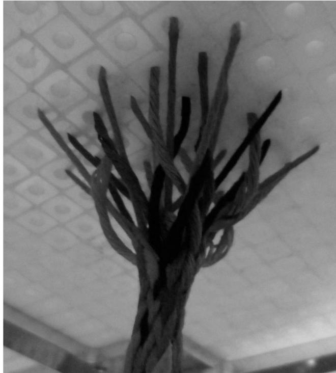
FIGURE 2.12 – Vue arrière de la matrice pendant la production d'une tresse en « 4-Step Braiding » avec la création d'une tresse entre le cantre et la matrice et les différences de tension entre les fils de la section.
