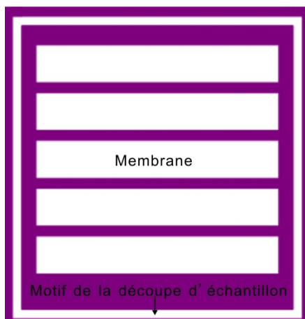
Figure 3- 22 : Masque de lithographie optique pour la gravure du substrat par la face arrière
