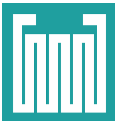
Figure 3- 29: Masque optique utilisé pour la réalisation de la résistance chauffante sur le concentrateur
