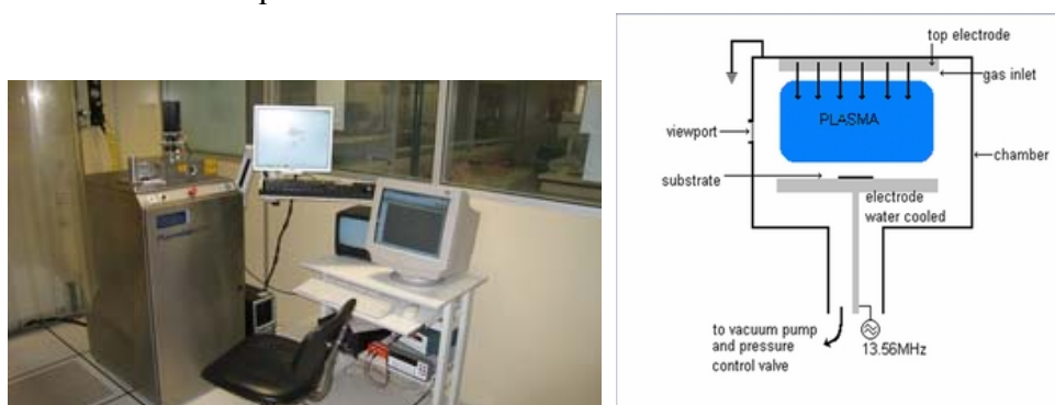
Figure 3- 9. Bati de gravure RIE Oxford Plasmalab 80 + (a) et son synoptique (b)
