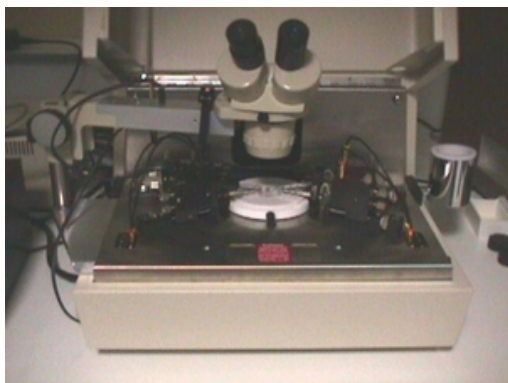
Figure 4- 4 : Système de mesure Effet Hall HL 5500 PC
