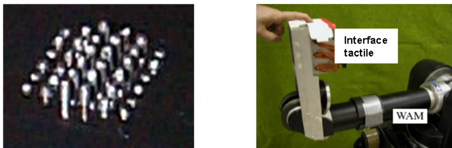
FIGURE 1.18 – Exemple de dispositif couplé tactile-kinesthésique utilisant une matrice de picots sur un bras de robot [WPF + 05].
