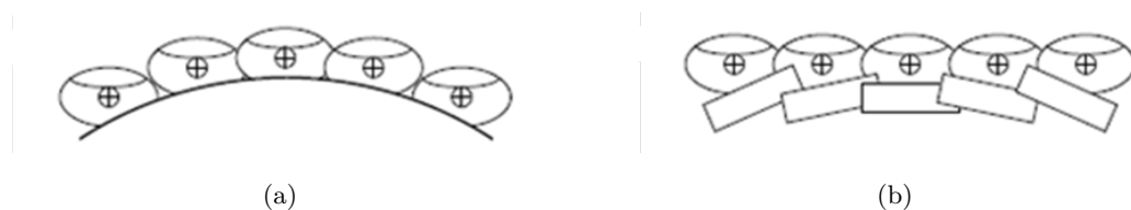
FIGURE 1.9 – a). Déformation normale du bout du doigt lors de l'exploration. b). Reconstitution de la zone de contact en fonction du déplacement [Hay04].
