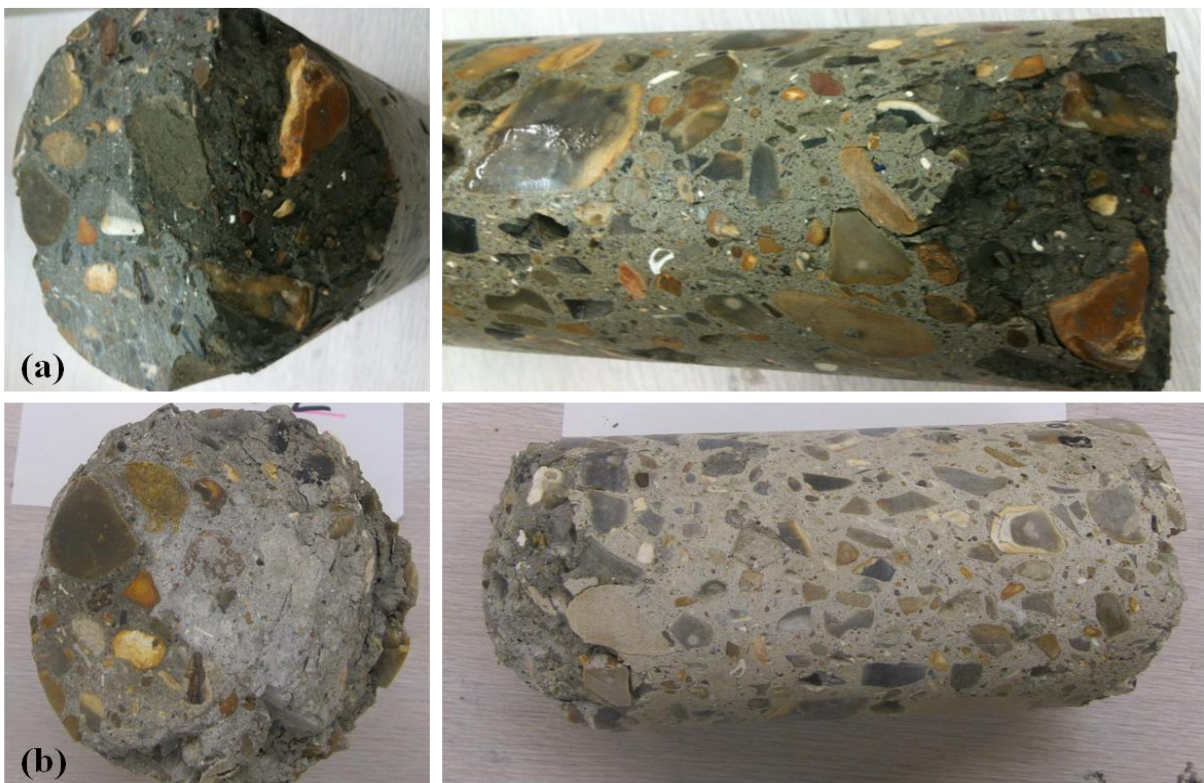
Figure 98: Echantillon du béton B2 du sédiment marin après 58 (a) et 85 (b) cycles gel-dégel
