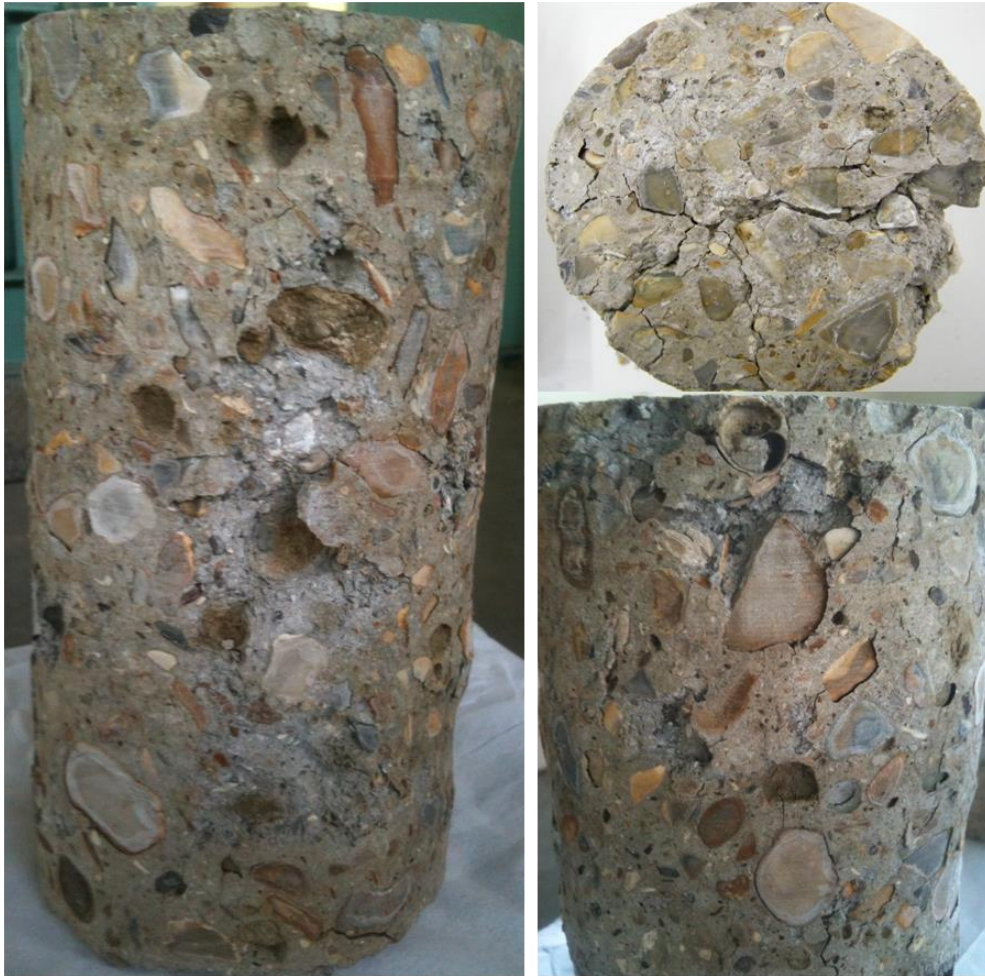
Figure 105: Dégradation complète du béton à 20 % après trois mois de cycles immersion/séchage à 105°C
