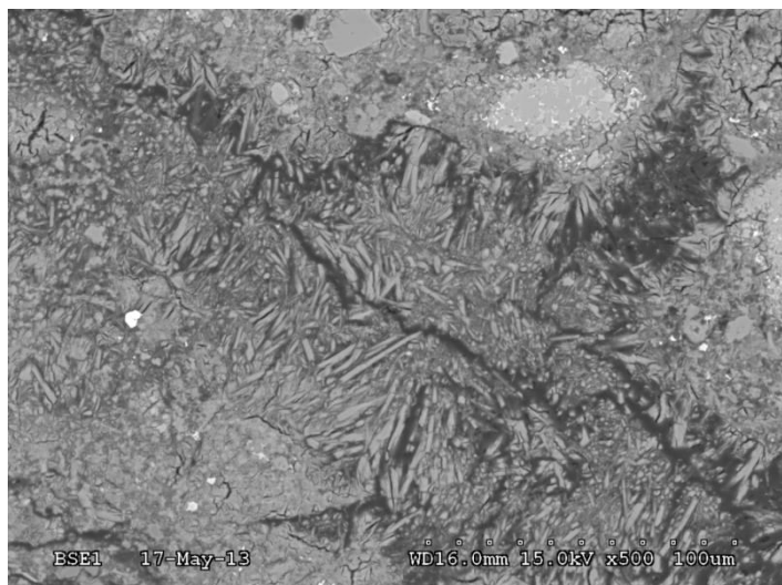
Figure 87: Identification d'ettringite dans les boulettes de sédiment du béton B1
