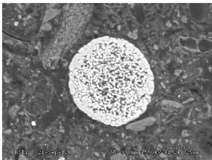
Figure 88: Présence de Pyrite framboïdale les boulettes de sédiment du béton B1
