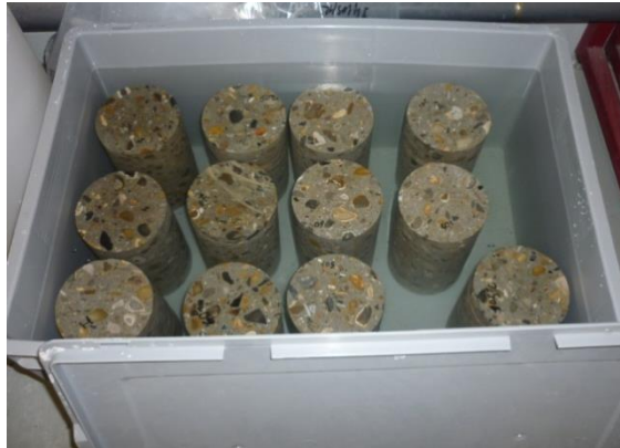
Figure 99: Immersion des bétons B1 et B2 dans une solution à 5% de \text{Na}_2\text{SO}_4 \cdot 10\text{H}_2\text{O}
