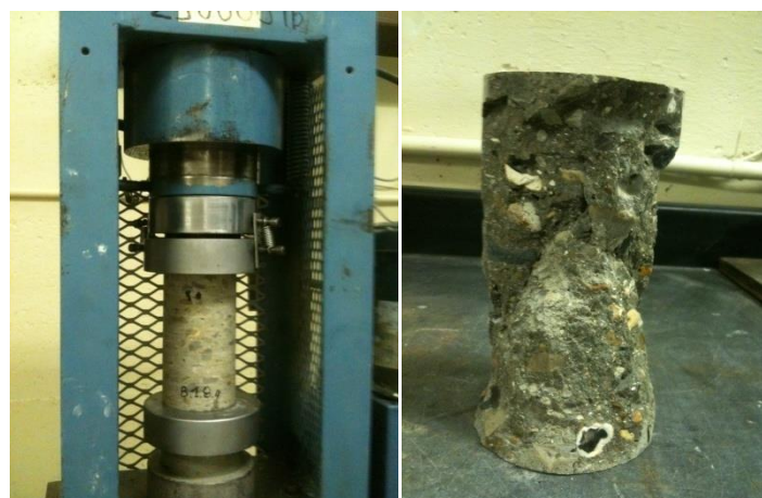
Figure 62: Essai de compression des éprouvettes à base de sédiment marin
