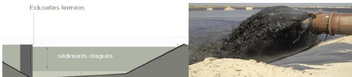
Figure 6: Concept et fonctionnement d'une lagune [Envisan, 2009]
