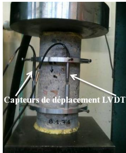
Figure 67: Dispositif de mesure du module d'élasticité à l'aide des capteurs LVDT
