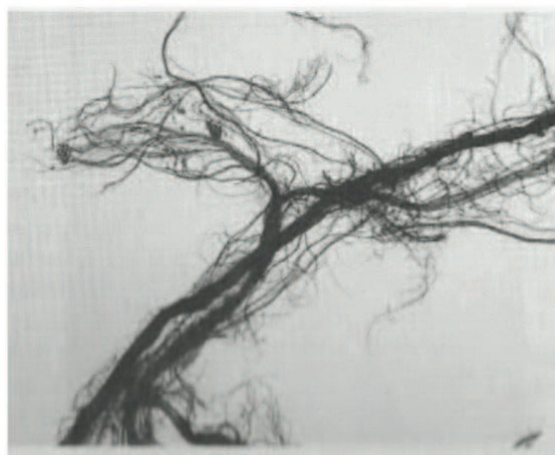
Figure 1-15 : Phénomène de fibrillation pour la fibre para-aramide, (Caramaro 2005)
