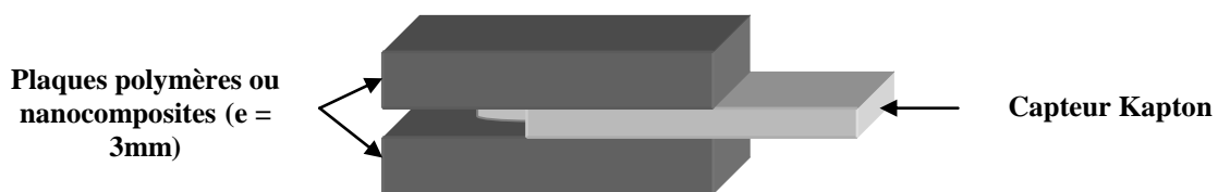
Figure A.15 Représentation schématique du capteur isolant en Kapton entre deux plaques polymères ou nanocomposites.
