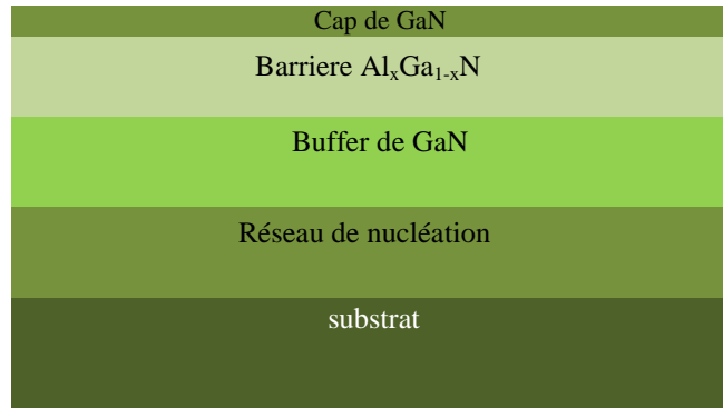
Figure I.12. Schéma représentatif de la structure HEMT AlGa x N/GaN
