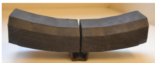
FIGURE 4.1 – Exemple de semelle de frein destinée au freinage ferroviaire
