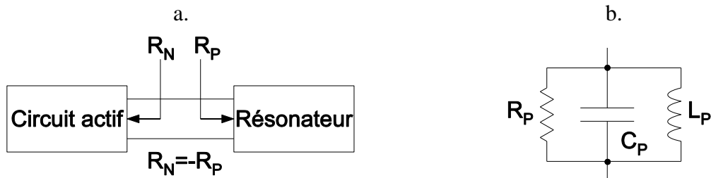
Figure III-24 : a. Vue un port d'un oscillateur ; b. Résonateur RLC
