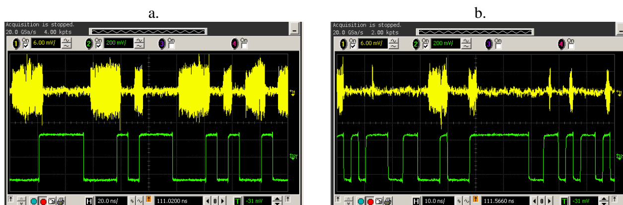
Figure III-39 : Captures d'écran des signaux d'entrée et de sortie de l'oscillateur : a. à 125Mbits/s ; b. à 375Mbits/s
