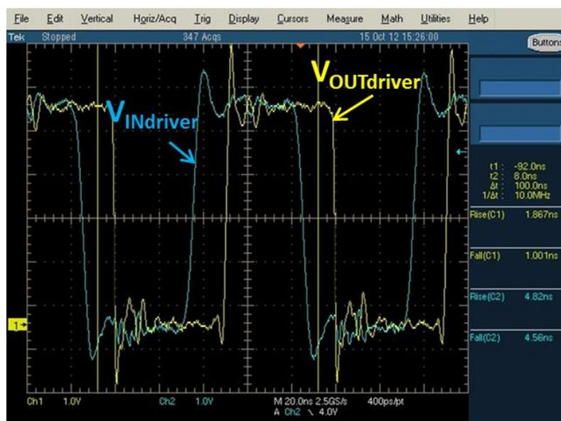
**Figure II.42** : signaux d'entrée et de sortie du driver LM5114 connecté à la grille du transistor NPTB00025,  $F_S=10$  MHz.
