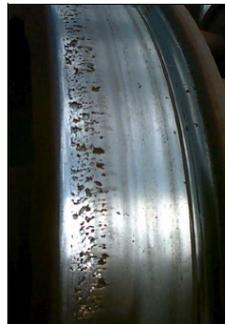
FIGURE 1.12 – Dommage final sur la bande de roulement : shelling
