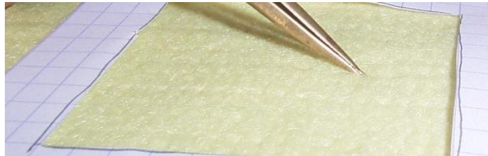
Figure 3. 35. Analyse expérimentale pour quantifier le nombre de fibres transportées- nombre d'impacts sur la couche supérieure du nontissé aiguilleté
