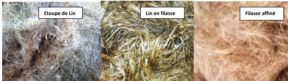
Figure 4. 1. Les différents types de fibre de lin mises en œuvre dans la fabrication des composites
