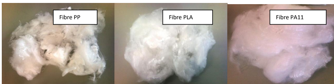
Figure 4. 2. Les différents types de résines mises en œuvre sous forme de fibres dans la fabrication des composites
