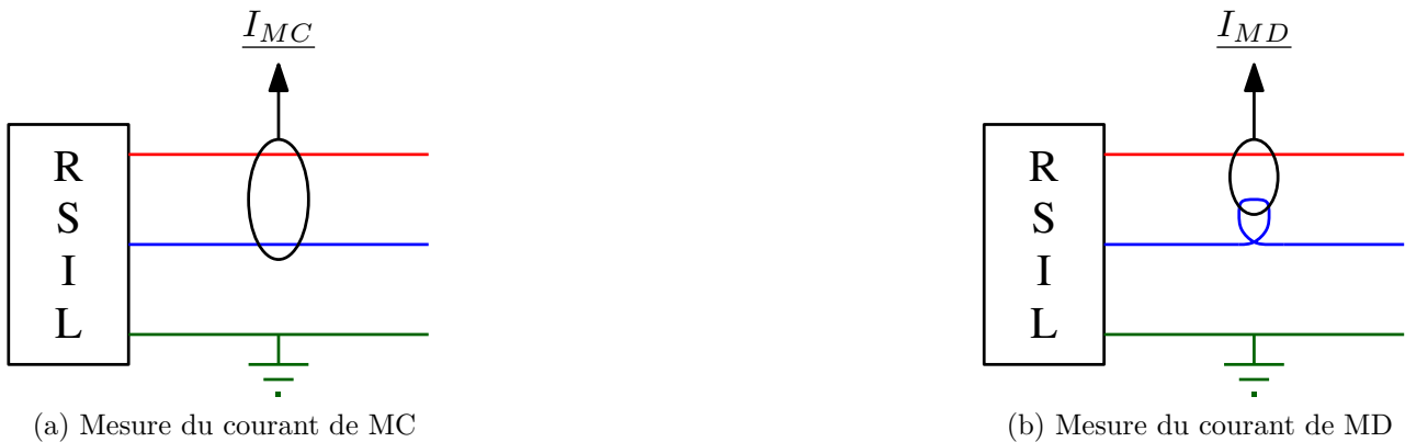
FIGURE 4.26 – Mesure des courants de MC et MD au niveau du RSIL à l'aide de pinces de courant
