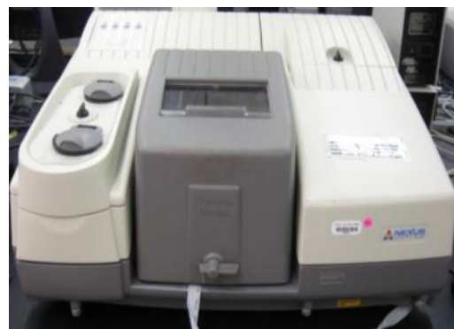
Figure 48: Spectromètre pour la caractérisation FTIR
