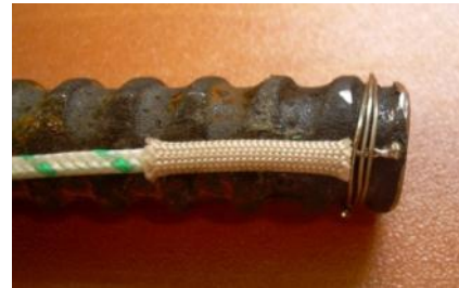
Figure 87: Fixation d'un TC sur une armature Diwidag
