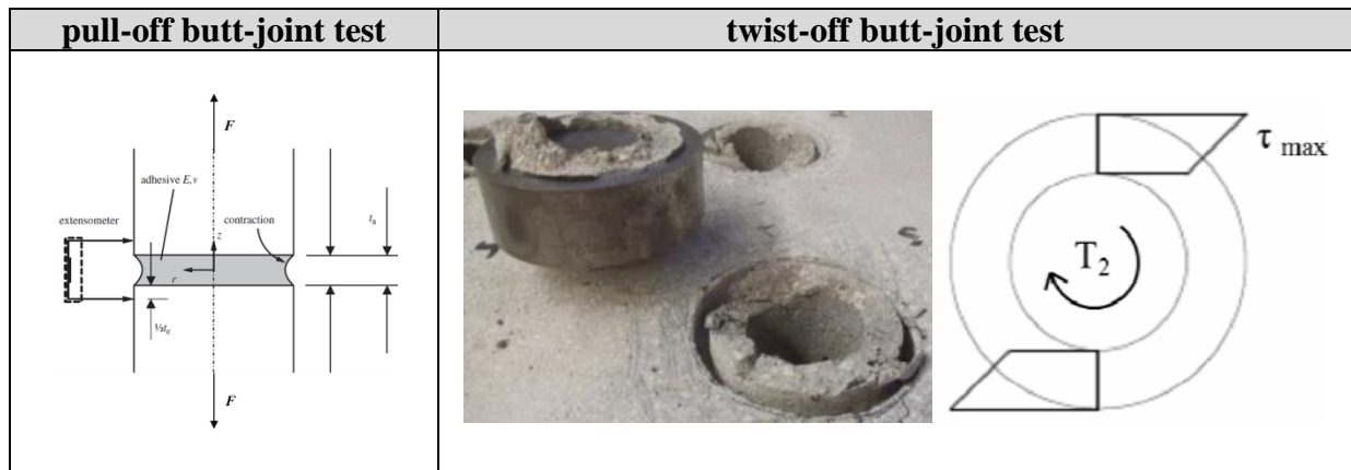
Figure 37: Pull-off butt-joint test (à gauche) d'après (Öchsner and Grácio, 2007) et twist-off butt-joint test (à droite) d'après (Verbovszky et al., 2012)
