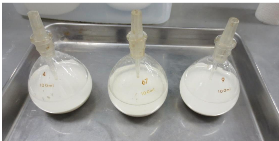
Figure 2.2: Détermination du poids spécifique des grains (Essais de pycnomètre)
