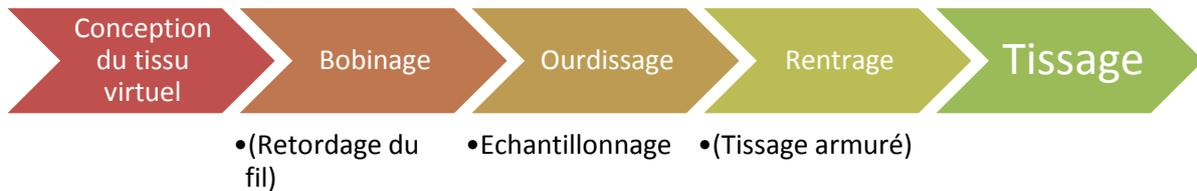
Figure III-1: Étapes successives de la réalisation d'un tissu armuré sur métier à cadres.
