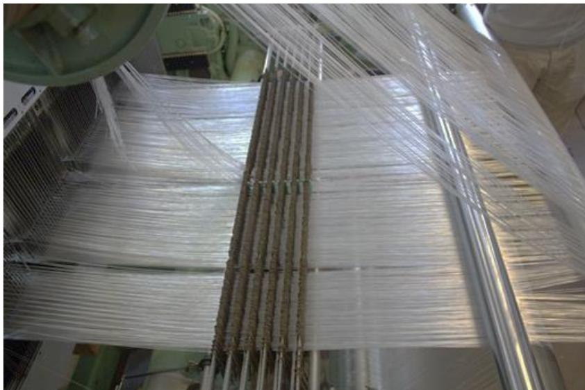
Figure III-15: Vue de profil de la machine à tisser, centrée sur les casse-chaînes.
