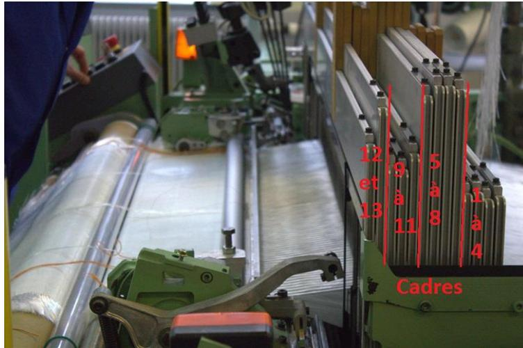
Figure III-4: Vue de profil de la machine à tisser Dornier, centrée sur la foule et le point de façure. Cadres numérotés de droite à gauche.
