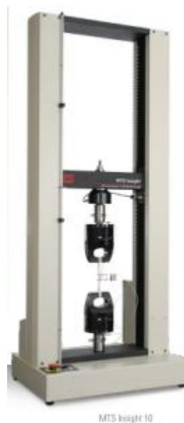
Figure II-6: Banc de traction MTS Insight 10, identique au modèle utilisé dans l'étude.[83]
