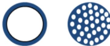
Figure II-5: Vue en coupe de la structure de fils enduit. En bleu l'enduction et en blanc les fibres. (à gauche) fil préenduit au PVA, fibres liées entre elles. Enduction au PEDOT:PSS/PVA sur le pourtour. (à droite) enduction à cœur du fil.[81]
