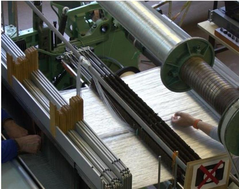
Figure III-13: Sélection d'un fil de chaîne avant mise en place d'un capteur.
