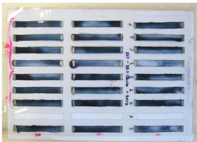
Figure II-1: Pistes d'enduction de PEDOT:PSS/PVA sur leurs moules.
