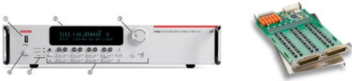
Figure II-10: Multimètre numérique Keithley 3706 et Carte d'acquisition Keithley 3724.
