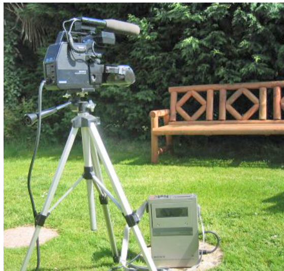
FIGURE 1.1 – Une des premières caméras portables. Il s’agit du modèle SL-F1 Betamax de Sony. L’enregistrement sur cassette se fait dans le boîtier relié à la caméra, qui peut être transporté par une seconde personne.
