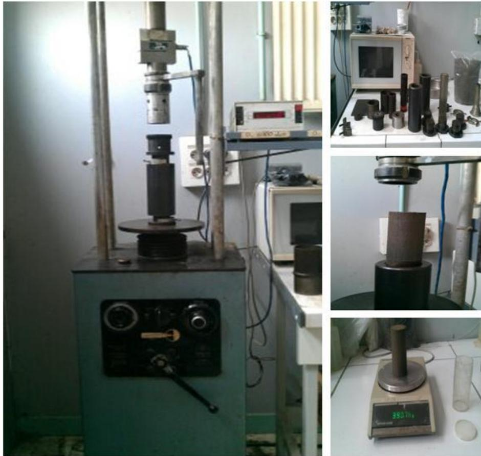
Figure 3.9 : Illustration de la confection des éprouvettes par compression statique
