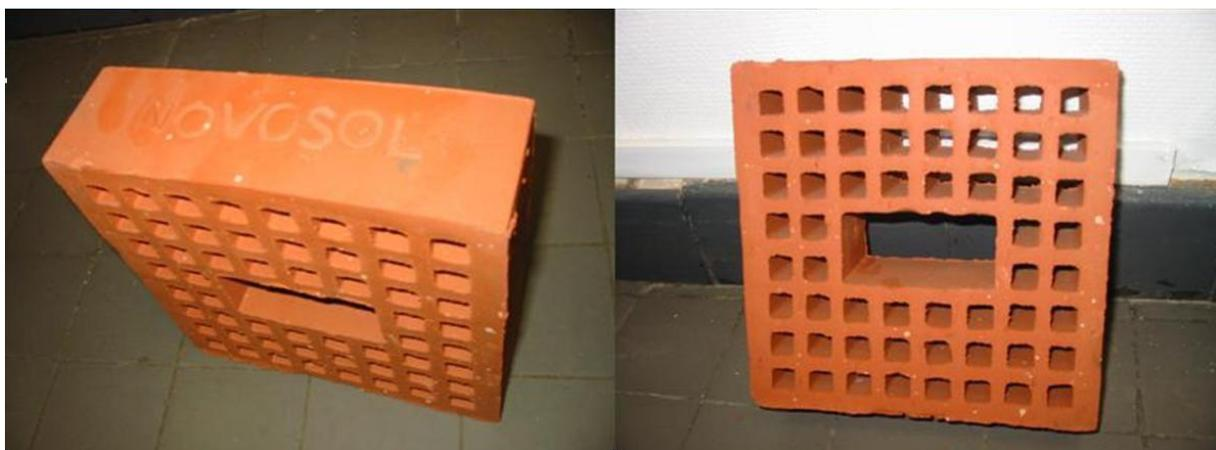
Figure 1.16: Briques 22x22 cm produites avec un taux de substitution de 15 % de sédiment fluvial traité
