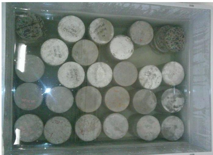
Figure 4.19 : Immersion des bétons B0, B10 et B20 dans une solution à 5 % de  $\text{Na}_2\text{SO}_4 + 10\text{H}_2\text{O}$
