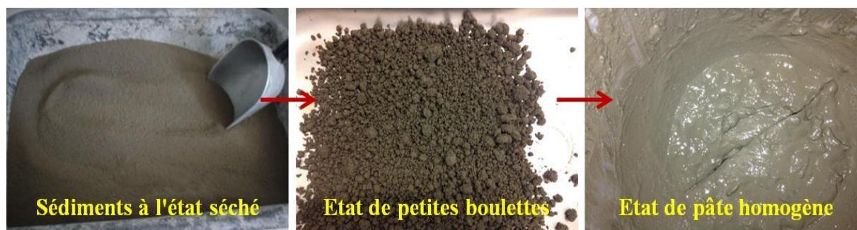
Figure 4.5 : Etat de sédiment GPMD lors de l'essai de demande en eau
