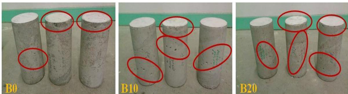
Figure 4.25 : Dégradation des bétons constatés après treize semaines d'immersion/séchage à 105 °C
