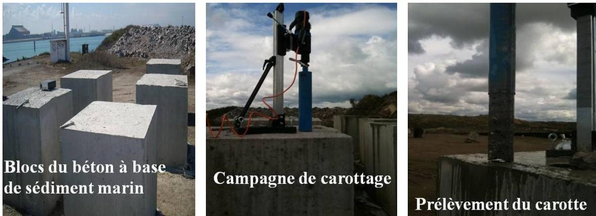
Figure 1.17: Campagne de carottage des blocs bétons à base de sédiments marins
