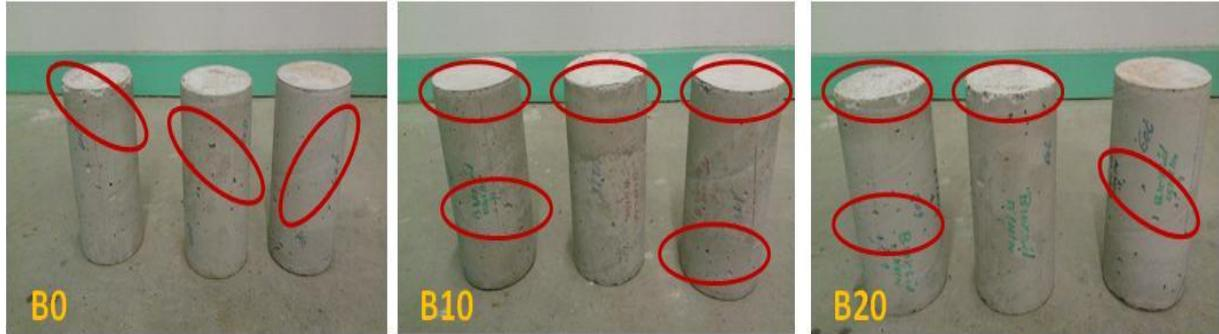
Figure 4.22 : Dégradation des bétons constatés après treize semaines d'immersion/séchage à 60 °C
