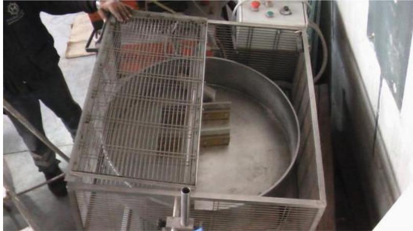
Figure 1.20 : Assiette granulatrice utilisée pour la production de granulats artificiels
