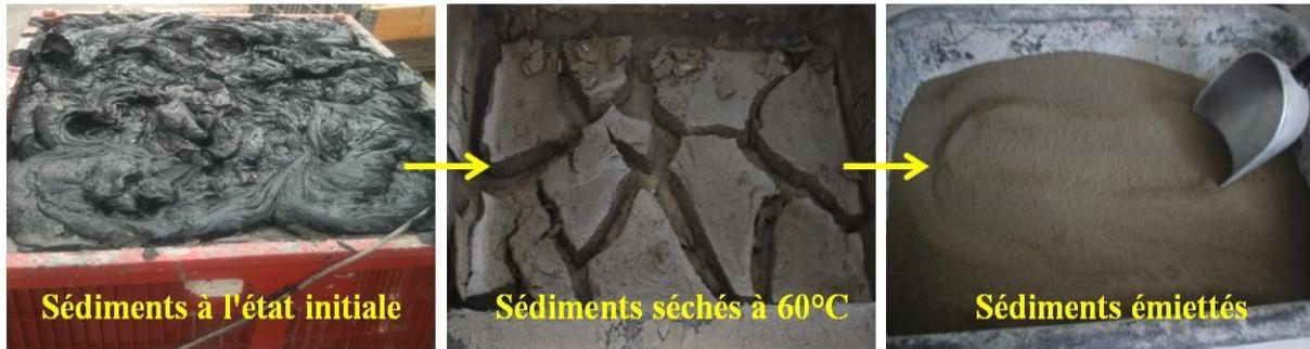
Figure 4.3 : Préparation des sédiments GPMD pour la formulation béton
