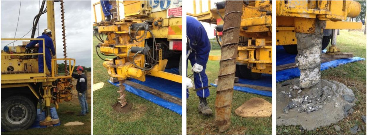
**Figure 3. 6** : Réalisation d'un sondage à la tarière hélicoïdale à sec
