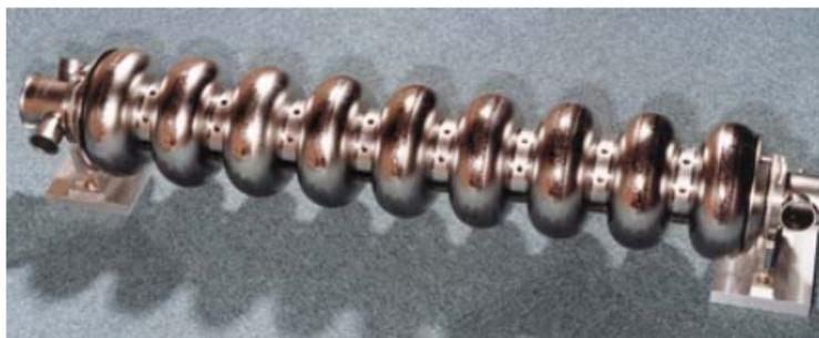
FIGURE 1.36 – Photographie d'une section accélératrice comportant 9 cavités accélératrices.
