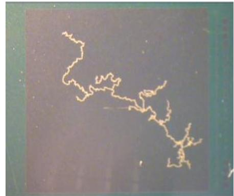
Figure 58: Photographie de la défaillance subie par l'ITO sous 40V.
