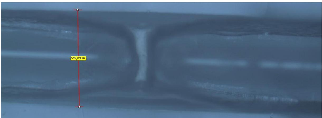
**Fig 1-67** : Rivulet en comportement D, valeur du ratio : 0,2 et angle de contact du liquide  $80^\circ$  (la partie supérieure du bombement commence à sécher sous la lumière du microscope et provoque la ligne visible au centre du rivulet).
