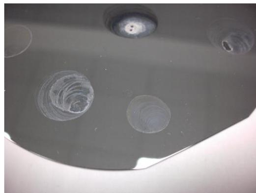
**Fig A-32** : Aspect des gouttes séchées sur wafer de silicium. La couleur blanchâtre est due aux résidus carbonés de CTAB.
