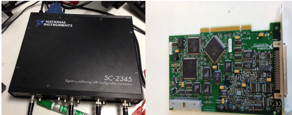
FIGURE 4.2 – La boîte de connexion des capteurs
