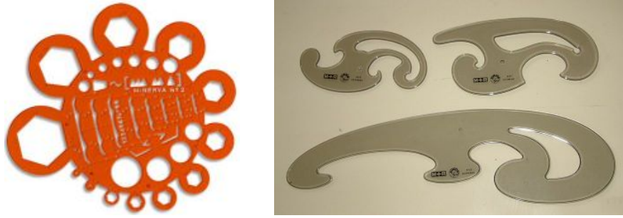
FIGURE 1.9 – Parents physiques des toolglass. À gauche, un trace-cercle (MINERVA Trace-écrous et boulons n°2) permettant de tracer des cercles de différentes tailles et diverses autres formes. À droite, une collection de pistolets de dessinateur servant à dessiner toutes sortes de courbes (issu de 11 ).
