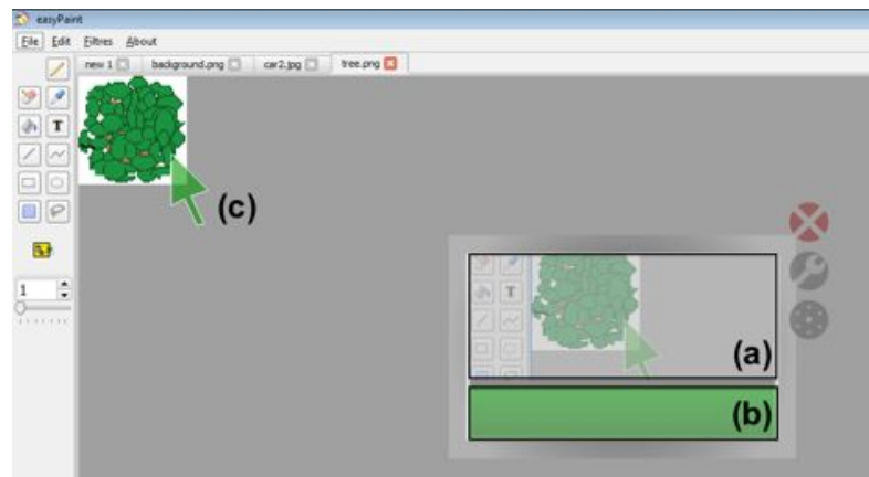
FIGURE 4.7 – WallPad dans une application de dessin. Le widget comporte une zone tactile rectangulaire (a) avec un bouton en dessous (b). Les doigts posés dans la zone tactile assurent un contrôle relatif du curseur (c). La région autour du curseur est affichée dans la zone centrale. Une couleur unique est attribuée à chaque couple WallPad (le bouton) et curseur afin de les identifier.
