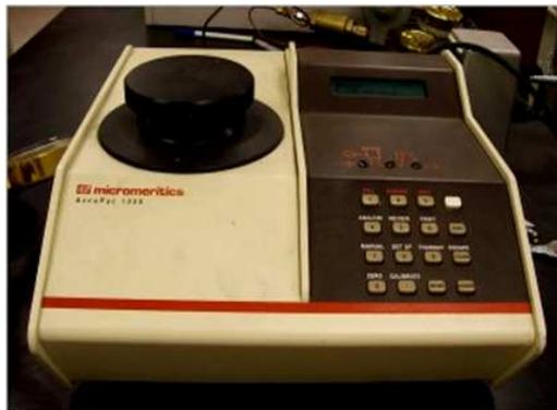
**Figure 2.6 :** Pycnomètre à hélium « MICROMERTICS-ACCUPYC1330 »
