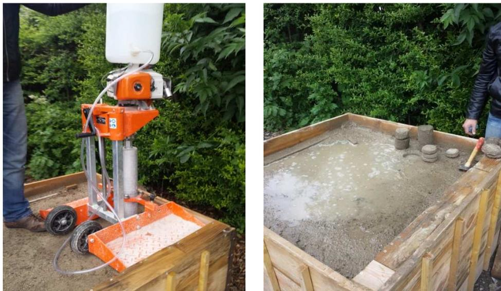
*Figure 4.36 : Carottage à 90j pour la planche expérimentale.*
