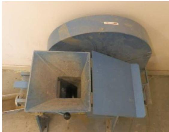
*Figure 4.2 : Appareillage utilisé pour le concassage des sédiments.*
