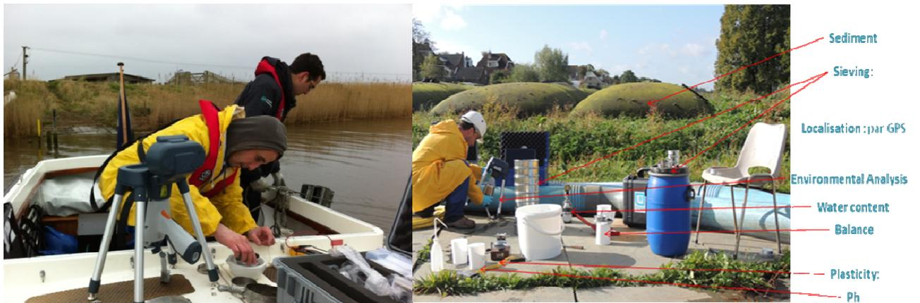
Figure 1.30 : Exemple d'une unité mobile de caractérisation des sédiments à terre et sur voie d'eau.
