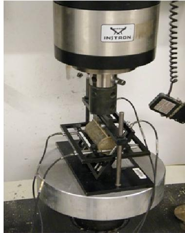
Figure 4.9 : Dispositif de mesure résistance en traction ( $R_t$ ) et module d'élasticité( $E$ ).
