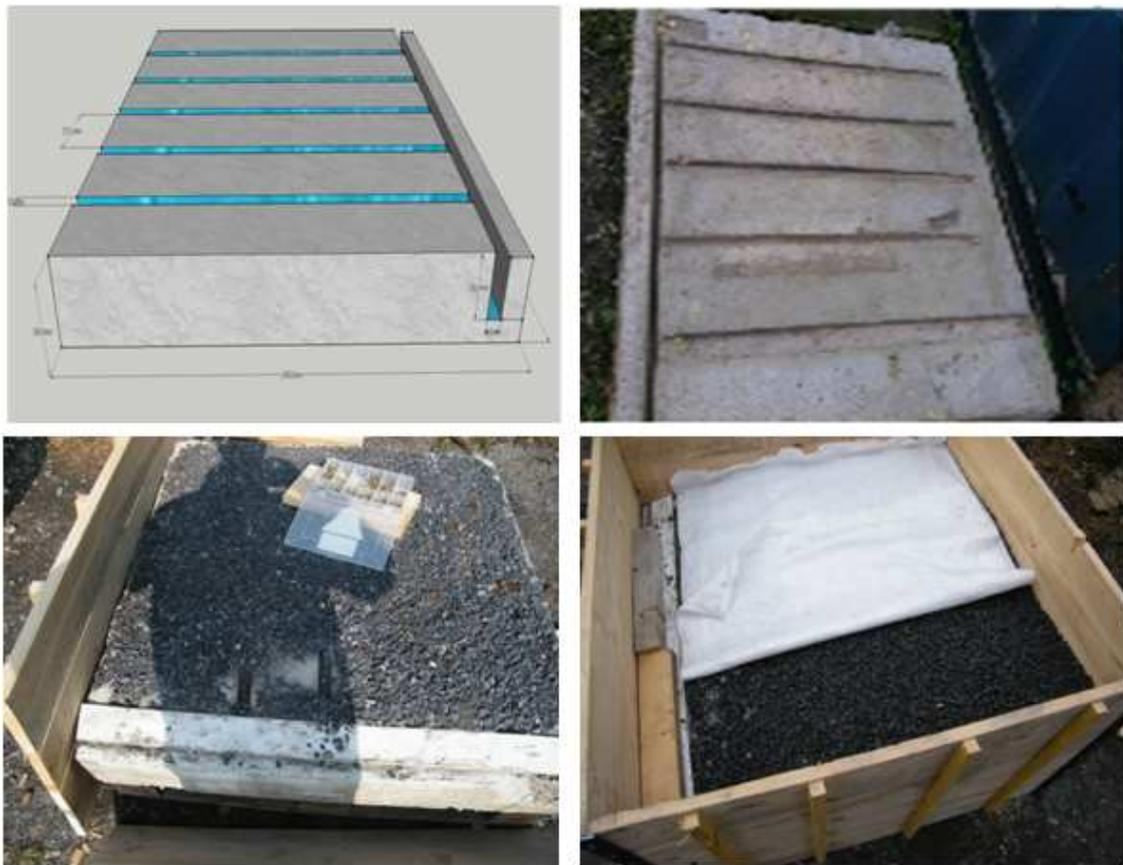
**Figure 4.33 :** Préparation de la plate forme de la planche expérimentale.
