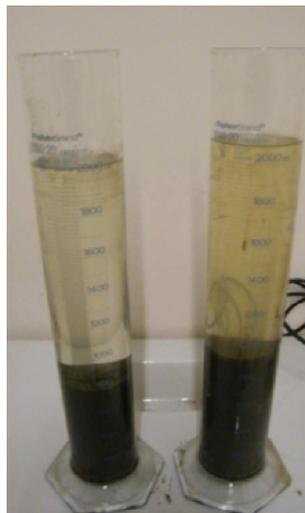
*Figure 3.8 : Colonnes des sédimentations de sédiments de la Belgique Bruts et floclés.*
