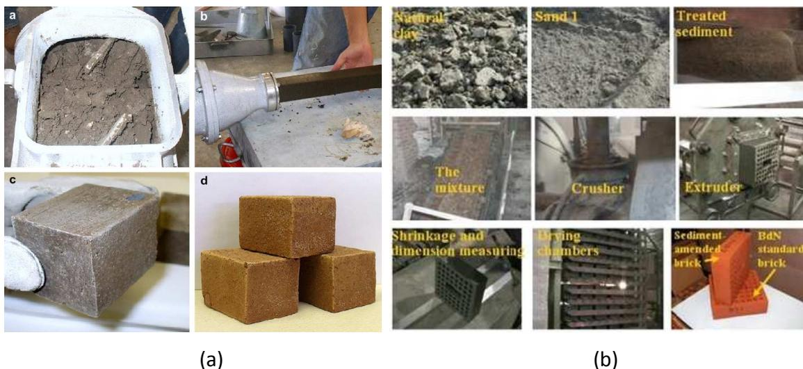
**Figure 1.23 :** *Processus de fabrication de briques à base de sédiments (a) (MEZENECVOVA.A et al, 2012) et (b) (SAMARA .M, 2007).*
