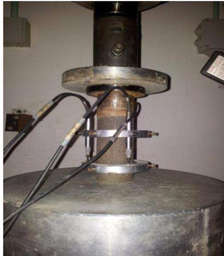
*Figure 4.7 : Dispositif de mesure résistance en compression.*
