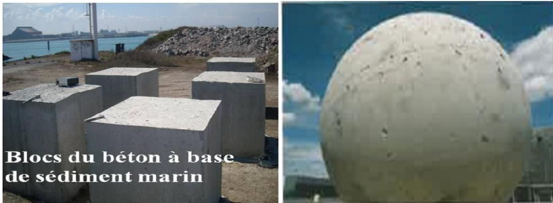
*Figure 1.24. : Bloc de Béton a base de sédiments marins (ACHOUR.R, 2013).*
