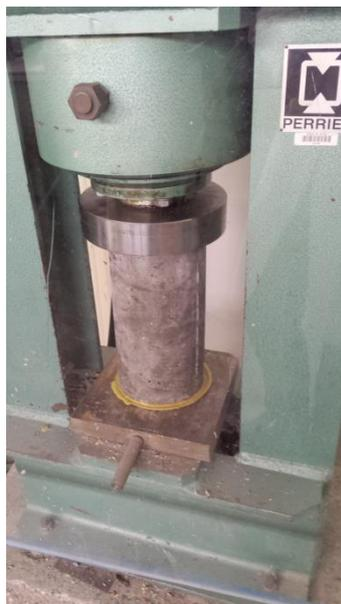
*Figure.III. 3. 11 Essai de compression sur un BRC*
