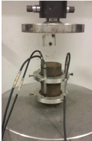
*Figure.III. 2. 11* Dispositif de mesure de module d'élasticité  $E_c$
