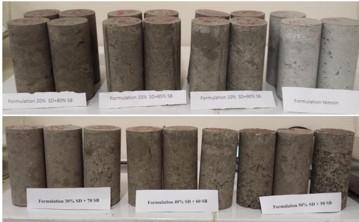
*Figure.III. 3. 9 Epreuves à base de sédiments fluviaux*
