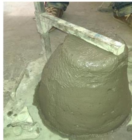
*Figure.III. 3. 13 Essai d'affaissement sur coulis*
