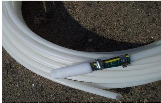
*Figure.III. 1. 28* Système manuel Waterra de pompage
