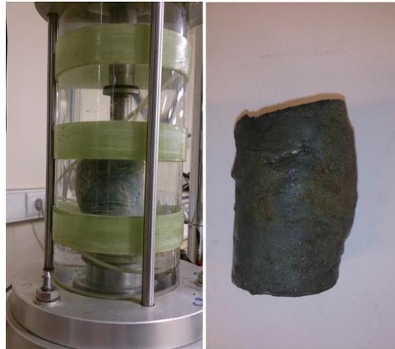
*Figure.III. 1. 14* Echantillon après cisaillement (CD)
