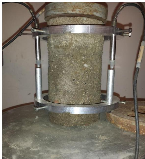
*Figure.III. 2. 18 Réalisation de l'essai de compression sur la carotte prélevée de la planche expérimentale*
