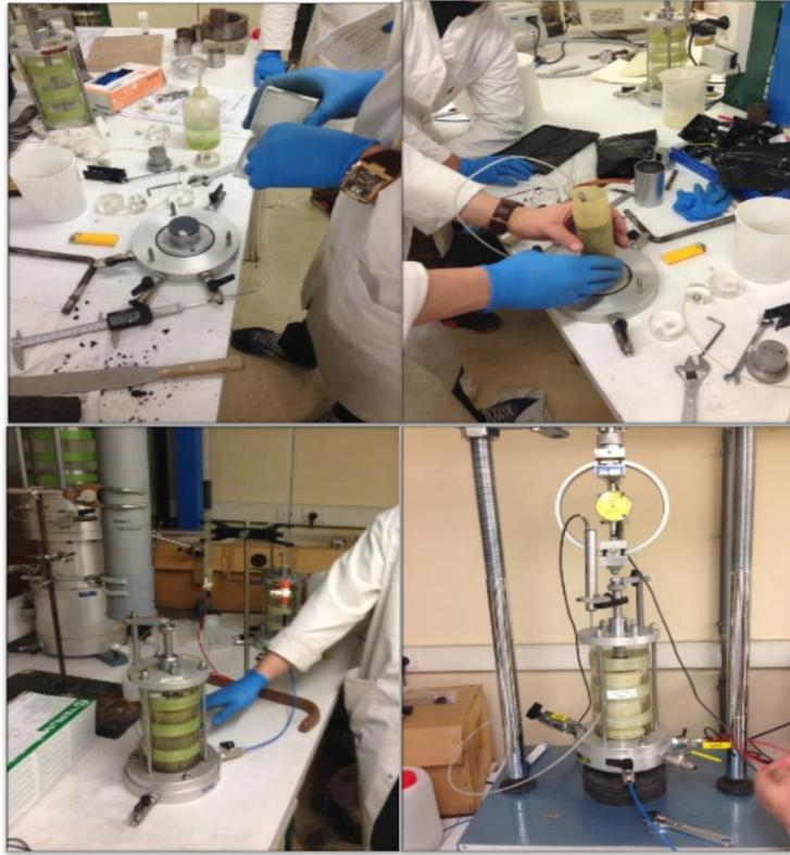
*Figure.III. 1. 10* Mise en place de la cellule pour l'essai triaxial
