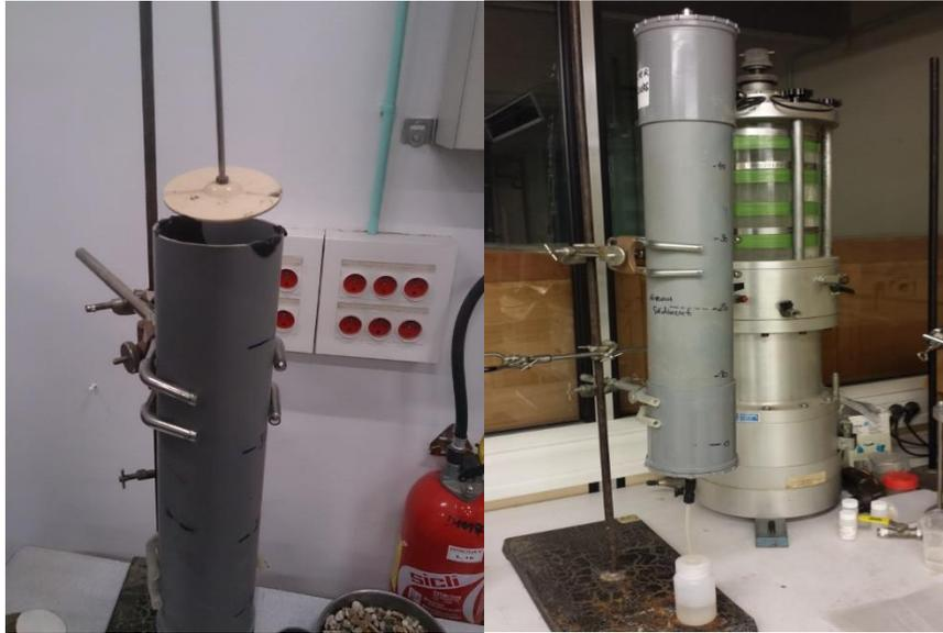
*Figure.III. 1. 31 Dispositif de l'essai de percolation*
