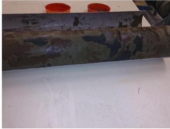
*Figure.III. 1. 23 Préparation de la carotte prélevée pour la réalisation de l'essai œdométrique*
