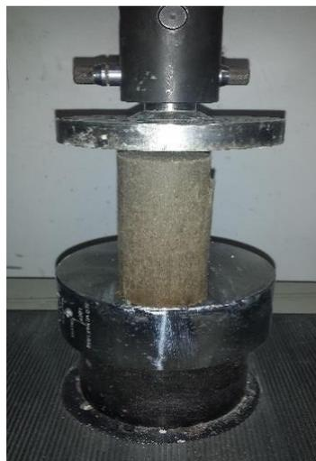
Figure.III. 2. 9 Dispositif de l'essai de compression simple
