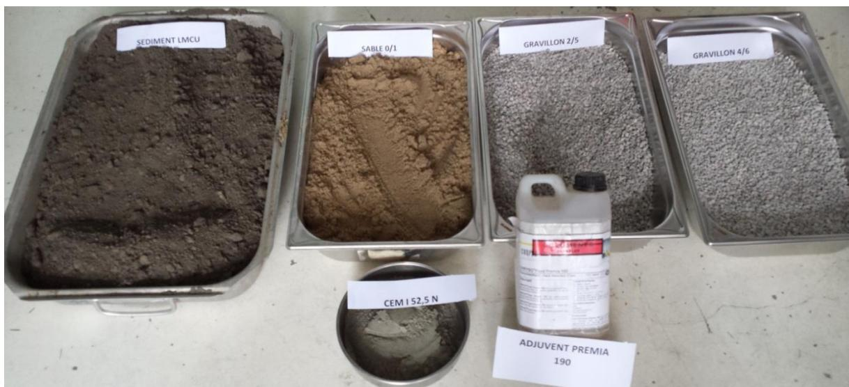
*Figure.III. 3. 7 Granulats utilisés pour la confection des éprouvettes BRC*
