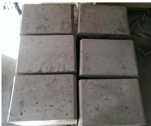
*Figure.III. 3. 5 Les blocs de béton après démoulage*
