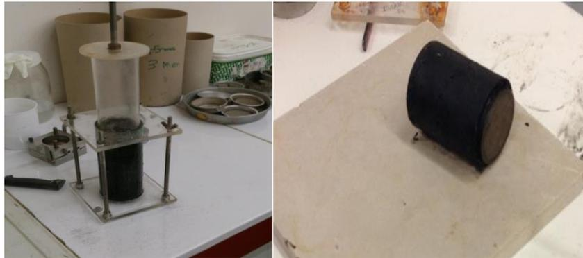
*Figure.III. 1. 3 Préconsolidation et préparation des échantillons*
