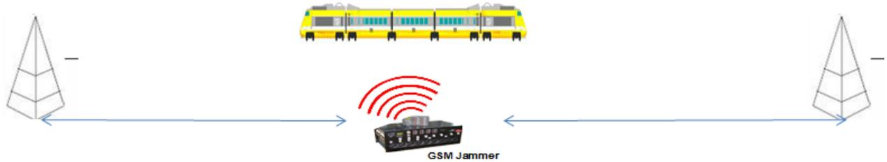
Figure 2.17 Brouilleur placé entre deux BTS.
