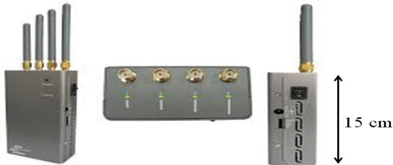
Figure 2.21 Brouilleur de poche utilisé lors des essais.
