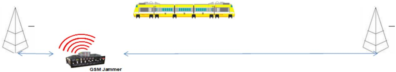
Figure 2.16 Brouilleur à proximité d'une BTS
