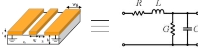
Figure I-11 : Circuit électrique équivalent de la ligne coplanaire
