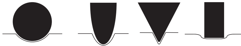
FIGURE 1.4: Géométries de pointes d'AFM. De gauche à droite: sphère, cône, pyramide, cylindre.
