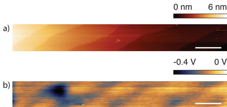
FIGURE 2.26: Mesure KFM avec Kolibri sur 6H-SiC. a) Topographie b) Image de potentiel. Barres d'échelle 1 \mu\text{m} .
