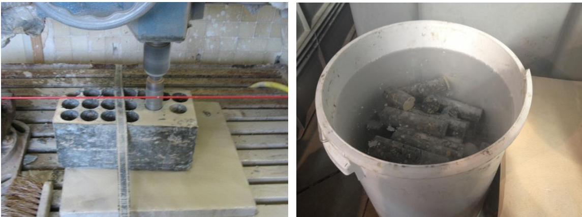
Fig. 2. 4 : Carottage et conservation de cylindres sous eau
