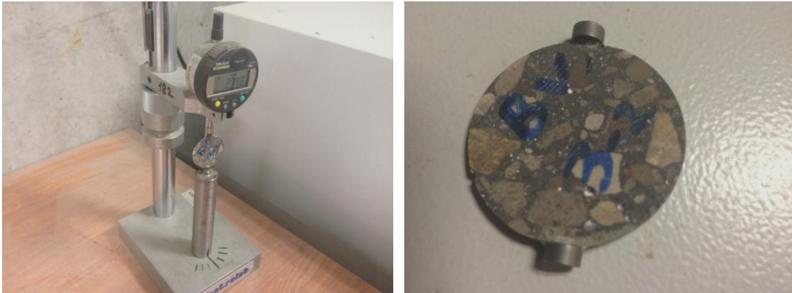
Fig. 2. 9 : Mesure de déformation de disque avec un rétractomètre
