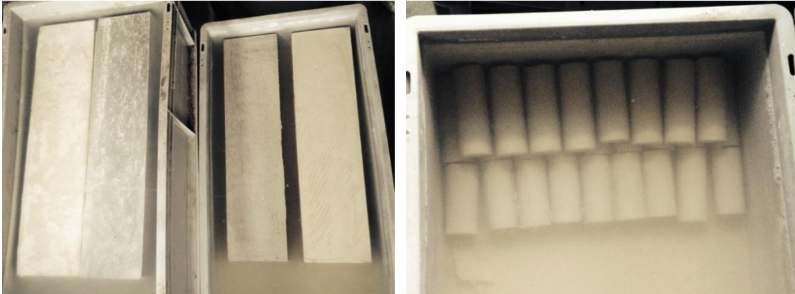
Fig. 2. 3 : Conservation des matériaux lors de la maturation sous eau
