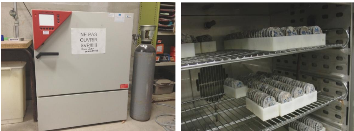
Fig. 2. 7 : L'enceinte climatique pour l'expérience de désorption de vapeur d'eau
