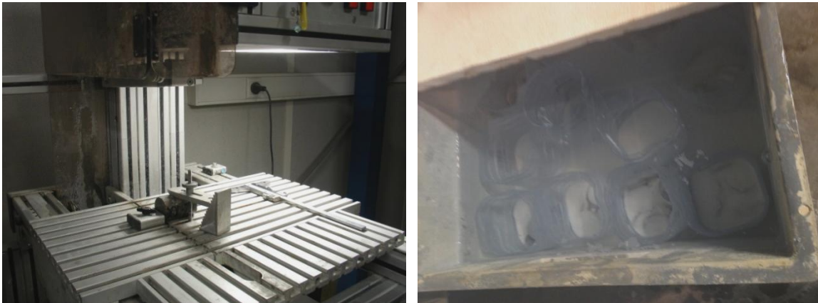
Fig. 2. 5 : Sciage et conservation de disques sous eau
