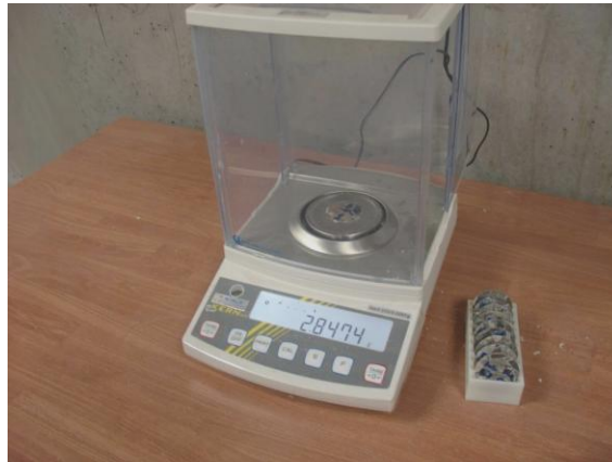
Fig. 2. 8 : Mesure de masse avec une balance précise au mg
