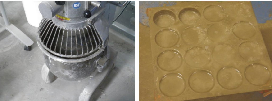
Fig. 2. 2 : Malaxage et coulage des mortiers et pâtes de ciment
