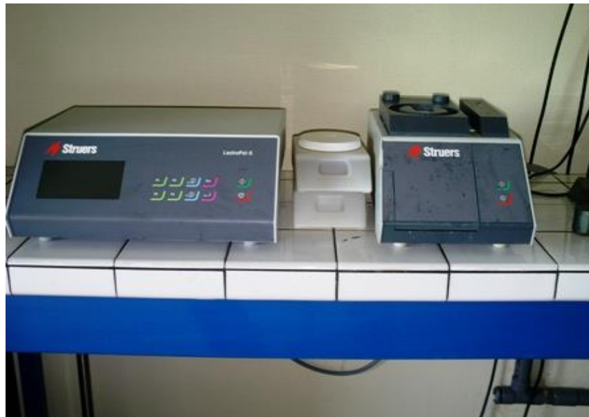
Figure II-5. Machine de polissage électrolytique Electropol-5 de Struers.
