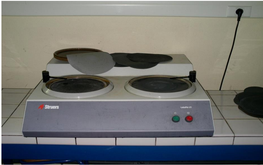
Figure II-4. Polisseuse mécanique Labopol-21.
