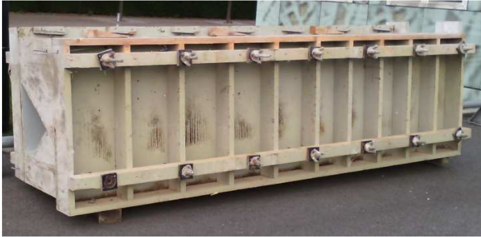
Figure 3.37 : Moule de la structure en béton armé (1 x 1 x 4) m 3
