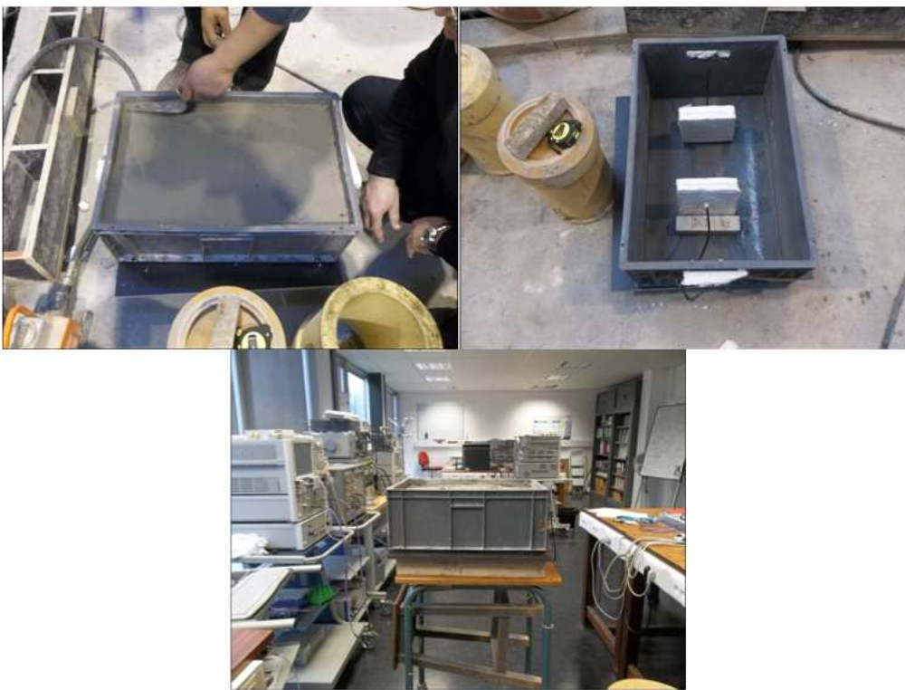
Figure 2.27: Ecoulement du béton sur les deux antennes patch
