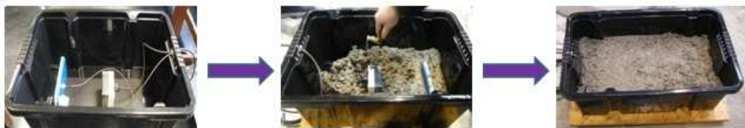
Figure 3.28: Capteur de température et d'humidité noyé dans la caisse de béton.
