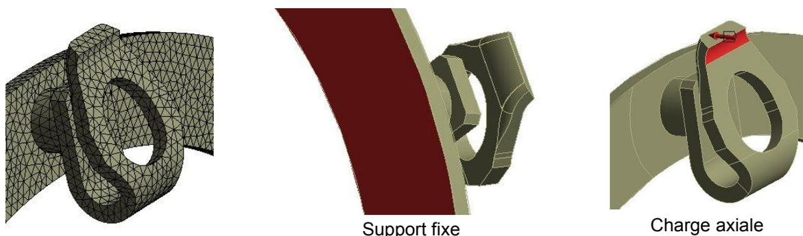
**Figure 2-6 : Modèle EF du crochet élastique**
