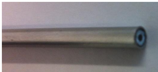
Figure III-4 : Photographie de la sonde coaxiale terminée par une ouverture de 2.985 \text{ mm} .
