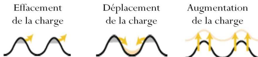
Figure 3.2 : Effets des actions du pilotage de charge sur la courbe de consommation.
