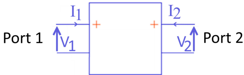
Figure A.1 : Représentations des paramètres de tensions et courants pour un quadripôle.
