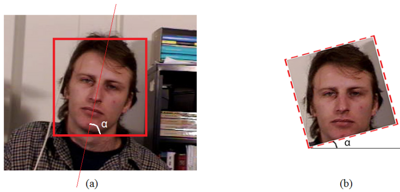
FIGURE 4.3: Détection de l'angle roll (a) et redressement du visage (b) afin de poursuivre l'estimation de la pose hors-plan.
