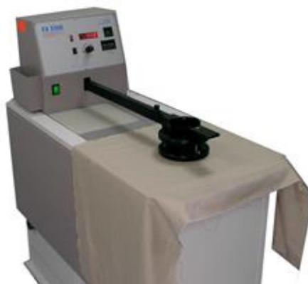
**Figure 2.18.** Photographie de l'appareil de perméabilité à l'air (FX 3300) [43]
