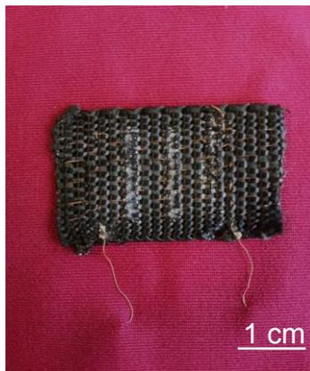
**Figure 3.27.** Photographie d'un fluxmètre thermique textile avec la technologie d'insertion en chaine, méthode additive
