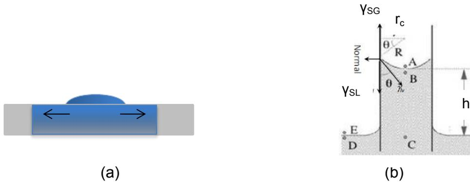
**Figure 2.14.** (a) Schéma de diffusion d'un liquide sur une surface poreuse par capillarité, et (b) représentation schématique simplifiée de ce phénomène [17, 19]
