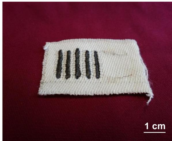
**Figure 5.17.** Photographie du fluxmètre thermique textile radiatif
