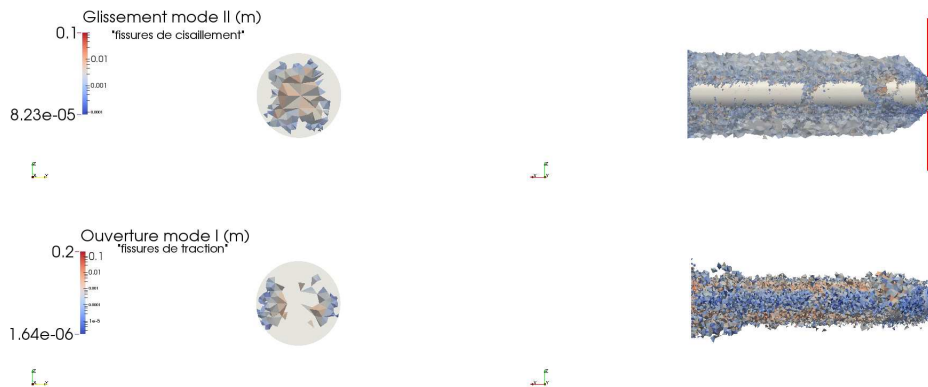
FIGURE 1.42 – Fissuration autour des parois (2 m après le front), galerie GED.
